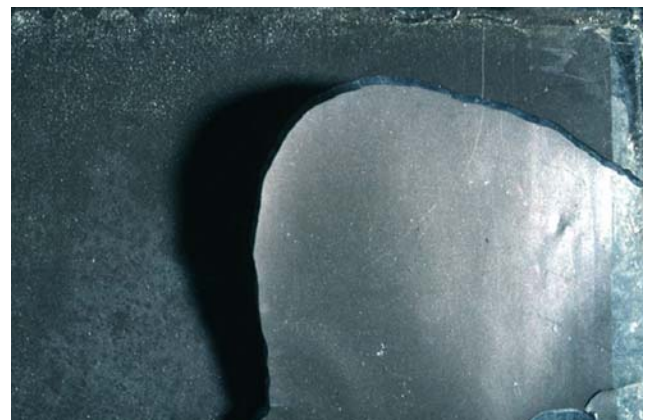
Løftet emulsion pga ringe luftfugtighed
